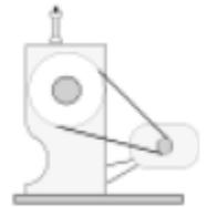
19) Para misturar o concreto, um motor de 3,5HP tem solidária ao seu eixo uma engrenagem de 8cm de diâmetro, que se acopla a uma grande cremalheira em forma de anel, com 120cm de diâmetro, fixa ao redor do tambor misturador. Quando o motor é ligado, seu eixo gira com frequência de 3Hz. Nestas condições, o casco do misturador dá um giro completo em
