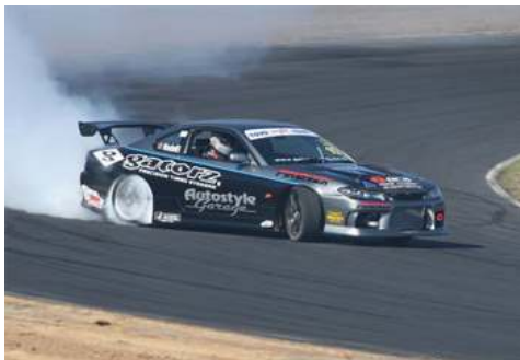
O carro perde aderência quando o pneu roda em falso.
